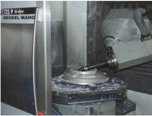
Seit über acht Jahren fräsen Norbert Schunder und Co 5-achsig mit Deckel Maho Maschinen.
